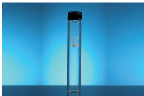
1 | Vidrio borosilicato. Tapón de rosca con junta PTFE
